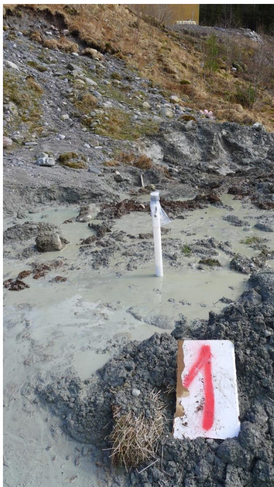
Figur 6. Prøvegrop B1. Biletet viser at det er høg vasstand i området og at det er mykje leire i grunnen.
